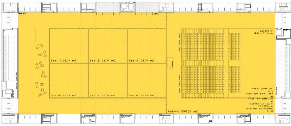
Imagen 37. Ejemplo configuración escenario y graderío (con capacidad para 576 butacas). Fuente: Fuente: Memoria del proyecto de ejecución de la Fase II del Palacio de Congresos de Santa Eulària des Riu (octubre 2022 revisión diciembre 2022)
